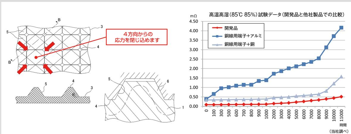
図に示す凸部材がアルミ材に食い込むことで、反発力を生み、接触部の合金層を維持します。
